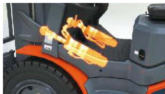
Cilindro de inclinación oculto.
