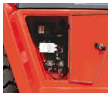
Gabinete eléctrico integrado independiente.
